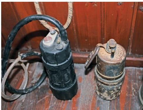
Plastična karbidna lampa ARIANE i čelična lampa FISMA iz aktivnog oružarstva SO-a HPD »Željezničar« (Vlado Božić)
