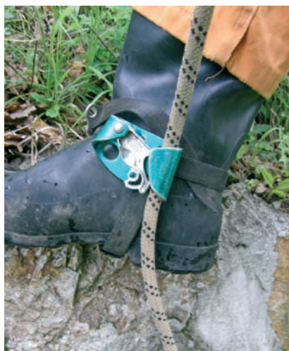
Pantin za desnu nogu ukopčan na užu (foto: Vlado Božić)
