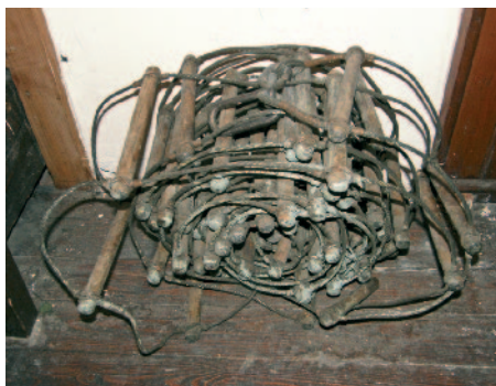
Ljestve s tankim drvenim prečkama, dužine 20 m (foto: Vlado Božić)
