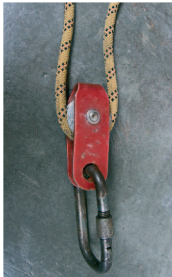
Jednostavna kolatura na užetu (foto: Vlado Božić)
