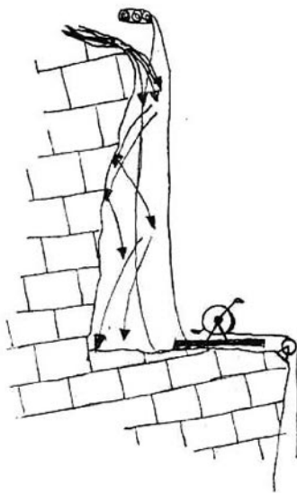
Zaštita vitla od slapa u Maloj Kicljevoj jami (crtež: Jura Posarić)
