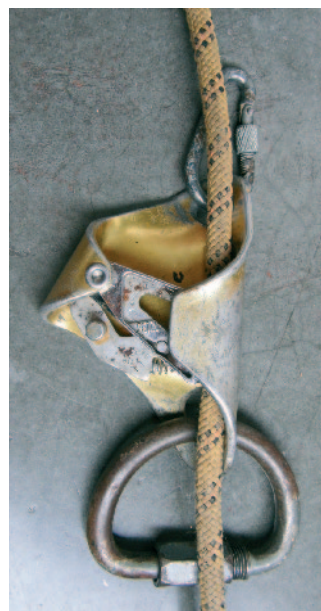
Trbušna stezaljka krol na užetu (foto: Vlado Božić)
