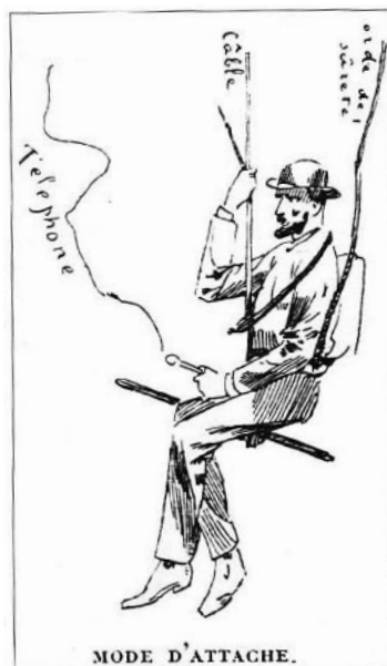
Primjena 'kmeta' s užetom za osiguranje i telefonom bila je modernija inačica ove tehnike koncem 19. st. (Minvielle, 1977)
