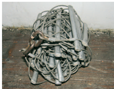
Ljestve s uskim aluminijskim prečkama, dužine 7 – 10 m (foto: Vlado Božić)
