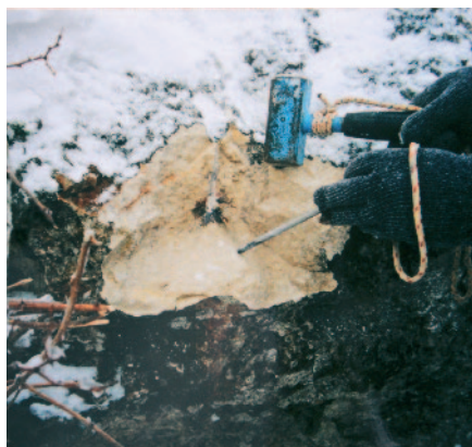
Prikaz djelotvornosti jednog Hilti metka - odvaljen komad stijene u kamenolomu Bizek (foto: Vlado Božić)
