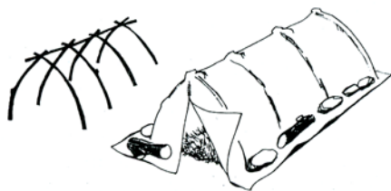
Crtež 8: Primjeri izrade skloništa uz korištenje plastične folije, šatorskog krila, astrofolije i sl.
