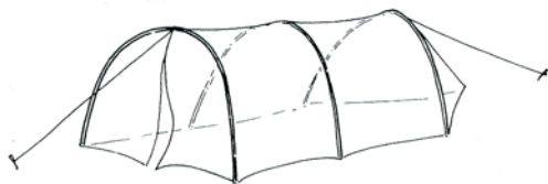
Crtež 17: Sklonište od plastične folije s rebrima od pocinčane žice.
