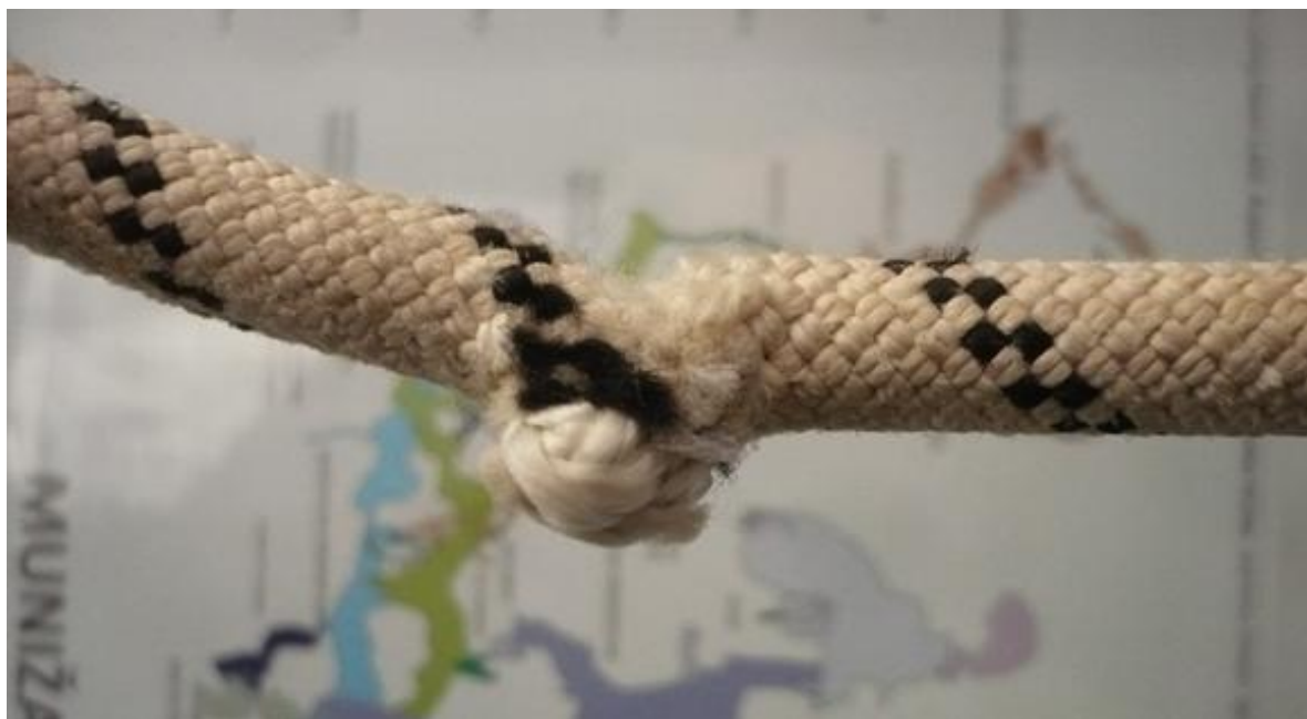
Slika 4. Uže oštećeno u vertikalni trenjem o stijenu, Foto: G.Rnjak
