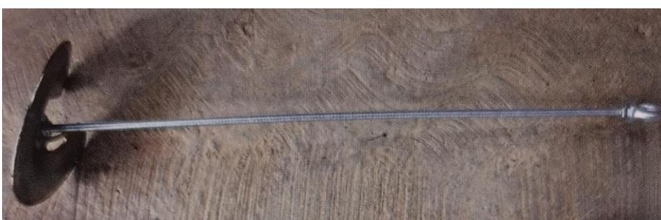
Slika 31: Inox šipka sa zavarenom podlogom koja služi za bolju stabilizaciju u muljevitom dnu, na vrhu je ring na koji se pričvrsti nit ([www.cnsas.it](http://www.cnsas.it))
