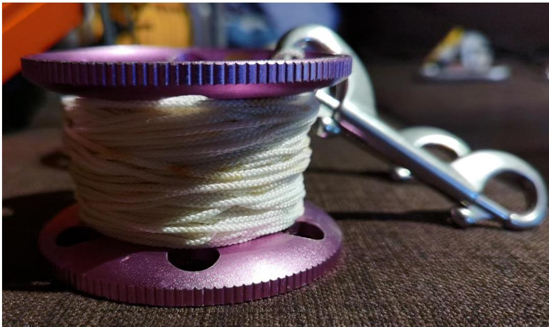
Slika 9: Metalni spool sa 20 metara namotane niti. (foto:D.Barnjak)
