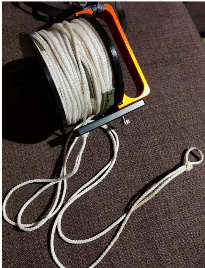
Slika 33: „Reel“ sa označenom niti dugom 120m, debelom 4mm označenom svaka 2 metra spremam za ronjenje.(foto:D.Barnjak)
