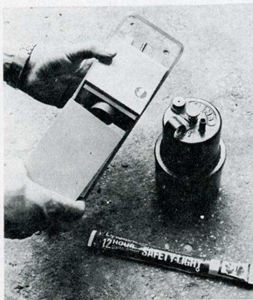
Slika 2. Usporedba nove acetilenske svjetiljke »Cible« i stare »Fisma«. Pored njih je najnoviji tip svjetileće cijevi »Cyalume« Foto: Z. Supičić
