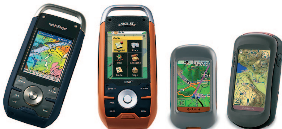
GPS uređaji (slijeva nadesno): Magellan Mobile Mapper 6 (6,9 cm), Magellan Triton 200 (6,9 cm), Garmin Dakota 20 (6,6 cm) i Garmin Oregon 550 (7,6 cm). U zagradama su navedene duljine dijagonale zaslona.
