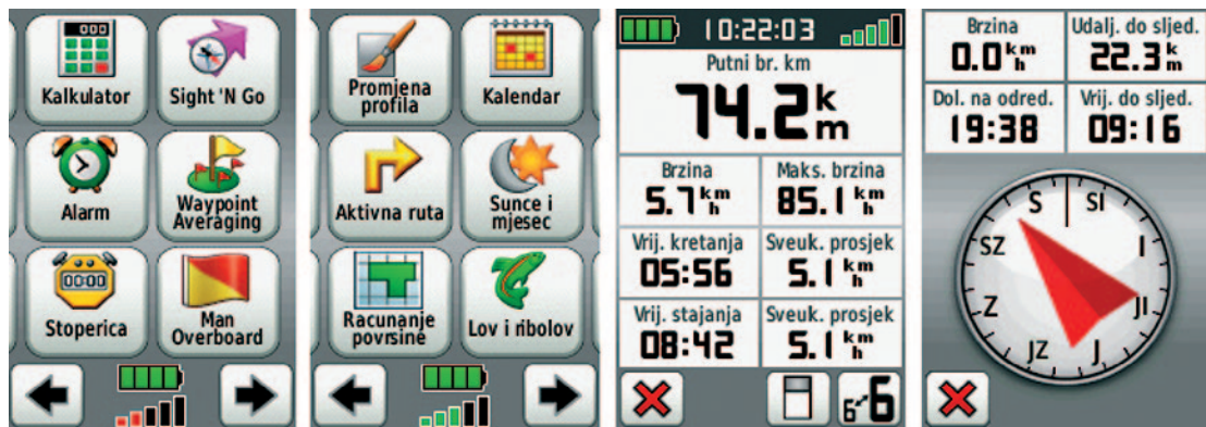
Prikaz dva izbornika, putnog računala i kompasa GPS uređaja Garmin Dakota 20.
