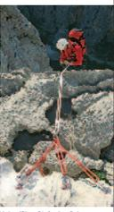
Mehaničko oštećenje užeta uže je naslonjeno na oštar brzd stijene
